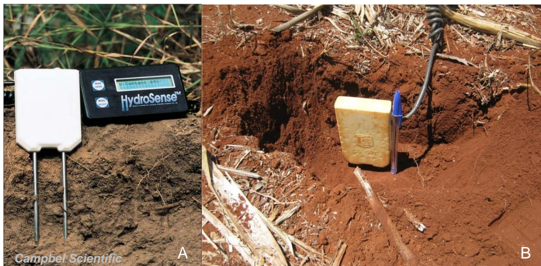
Figura 2.2. Detalhes do equipamento TDR utilizado (“HydroSense” CD620/CS620®) composto pelo visor CD620 (direita), sensor CS620 (esquerda), com duas hastes de aço (A) e das hastes inseridas no solo durante a leitura (B).
