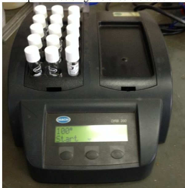
Foto 17 – Aparelho digestor modelo DRB 200 usado para digerir as amostras de demanda química de oxigênio e fósforo total.
