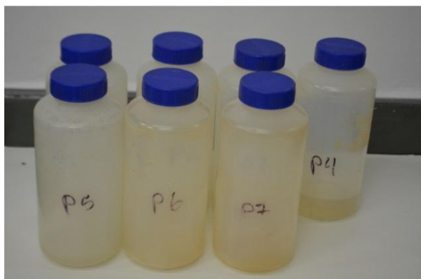
Foto 13 – (A) Frascos usados para amostragem de turbidez, cor aparente, cor verdadeira e concentração de sólidos suspensos, (B) frascos usados para amostragem de demanda bioquímica de oxigênio.
