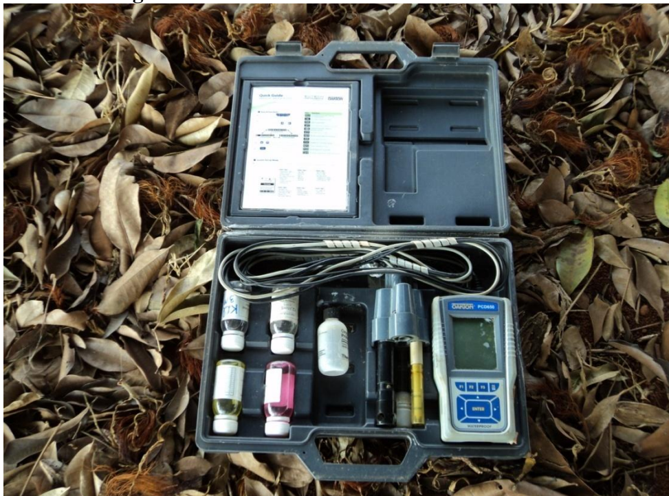
FIGURA 10 - Aparelho Multiparâmetro Oakton utilizado para a coleta de dados limnológicos.
