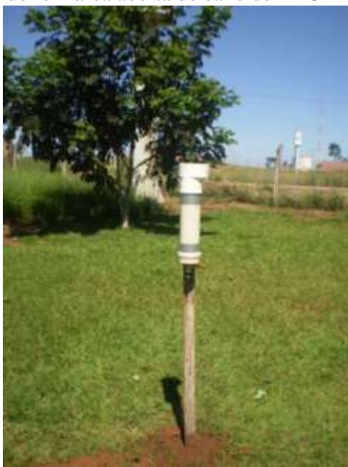
Fotografia 4 - Pluviômetro totalizador em área aberta de cano de PVC
